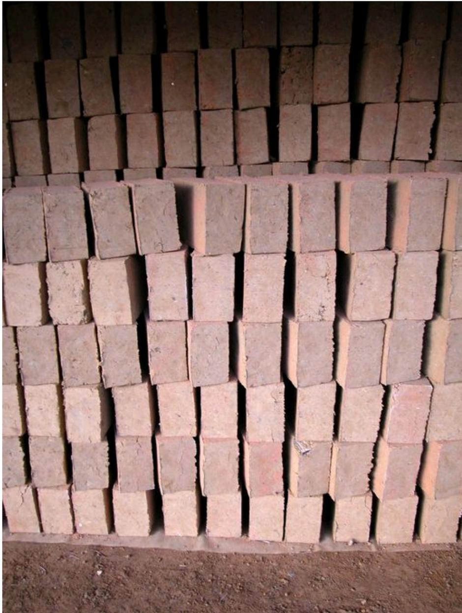
Détail des briques crues en cours de séchage sous les hallettes.
