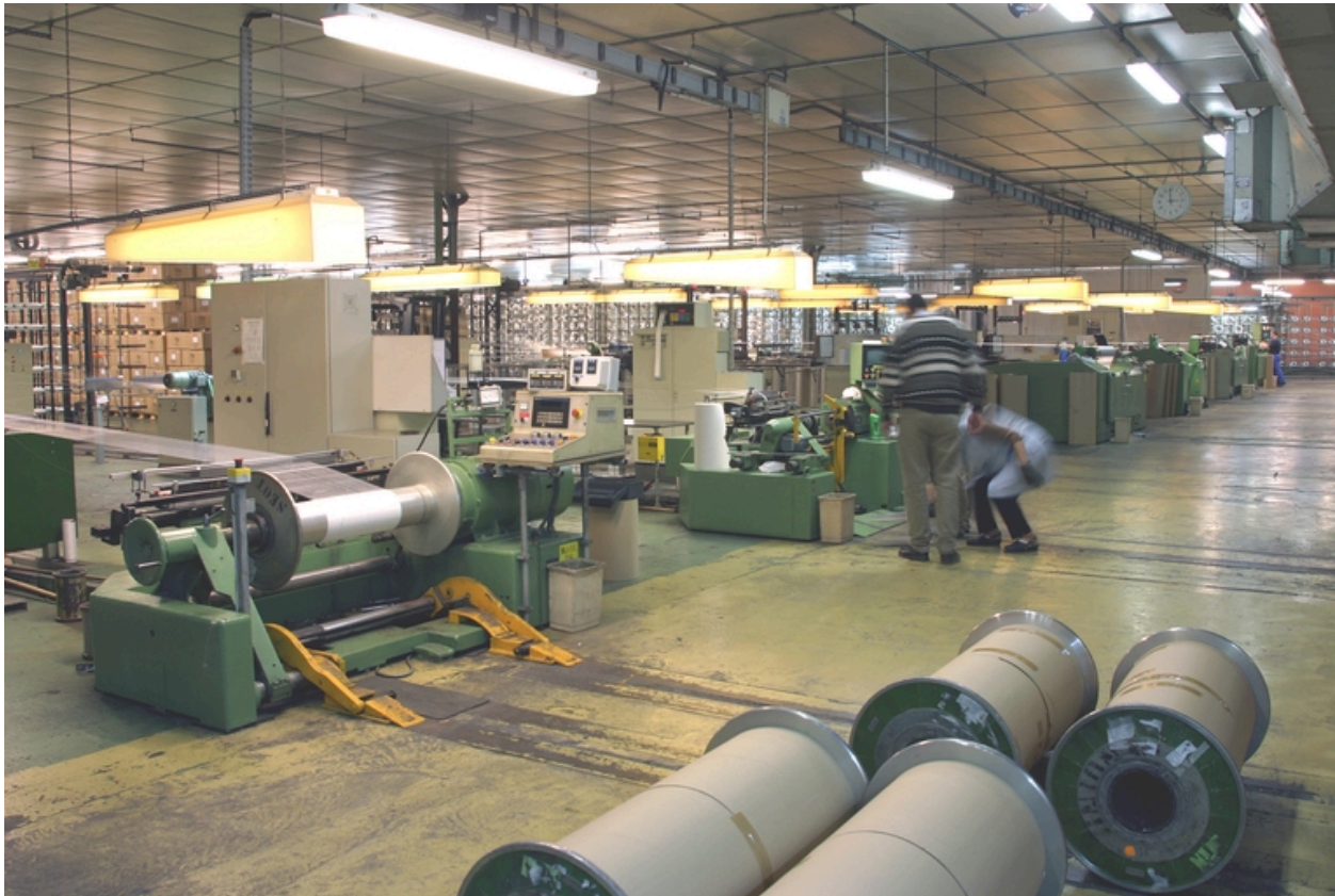
Vue intérieure des ateliers de fabrication : les ourdissoirs.
