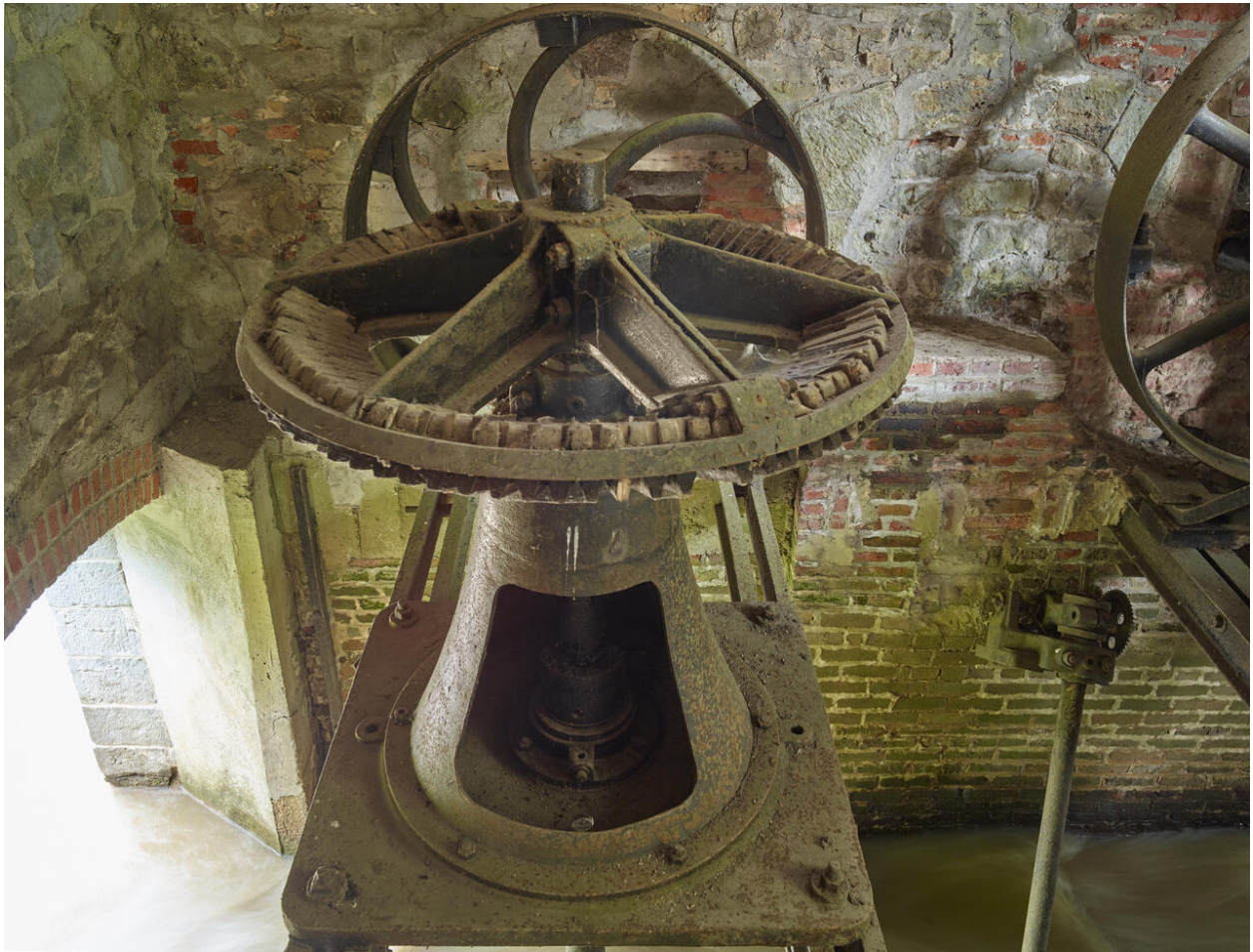
Le Petit moulin. Vue intérieure du système de transmission.
