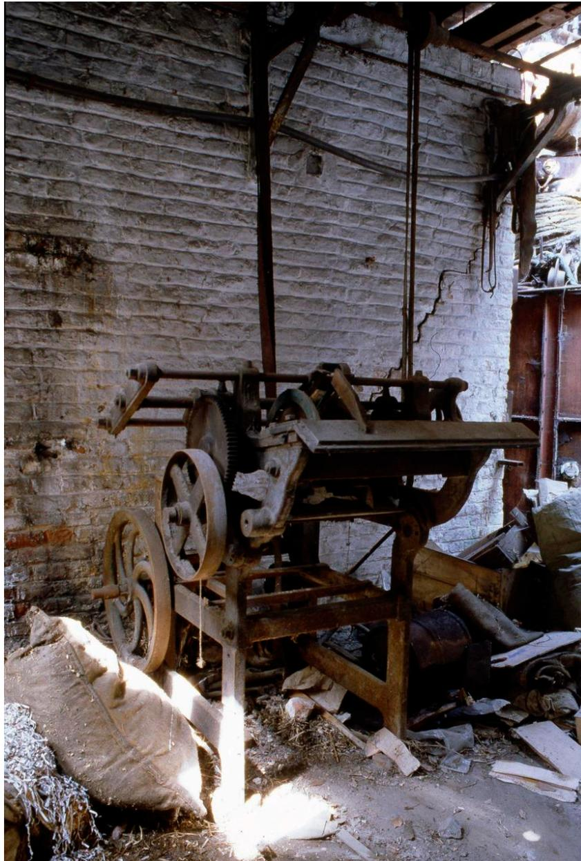
Atelier de fabrication. Machine à rogner (rogneuse).
