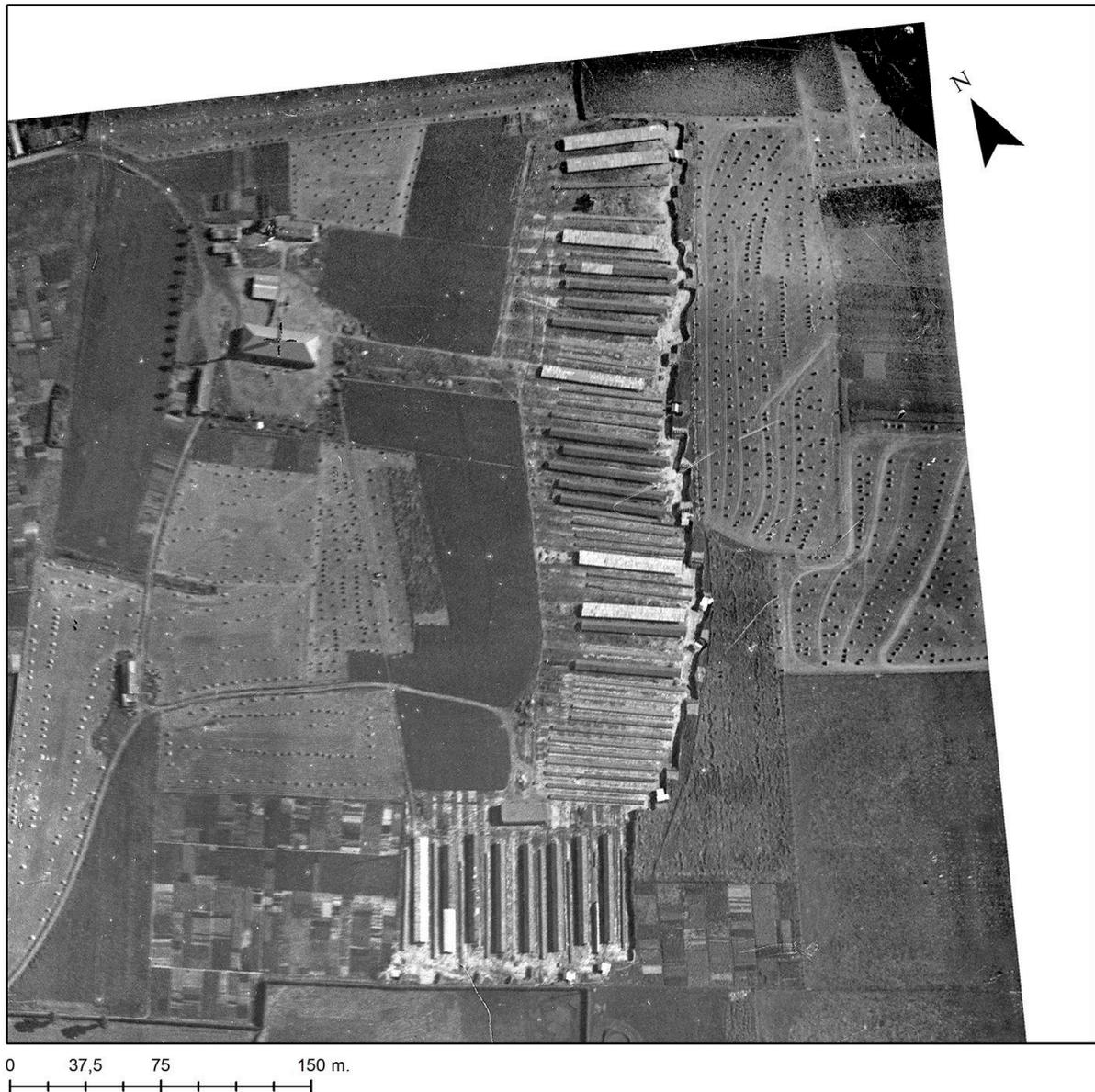
La briqueterie (en haut à gauche) et ses séchoirs (au centre) en 1930. Ces derniers, placés en contrebas du champ, laissent penser qu'ils sont déplacés un fur et à mesure de l'exploitation de l'argilière (Source IGN. Photothèque nationale. 1930).
