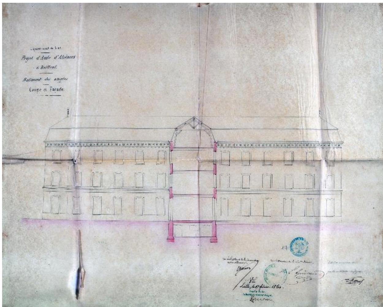
Projet de construction, bâtiment dit pavillon d'angle ou pavillon des angles, coupe transversale de l'aile en retour d'équerre montrant l'élévation de la façade postérieure du corps de logis principal par les architectes Marteau et Mourcou, 22 novembre 1858 (AD Nord).
