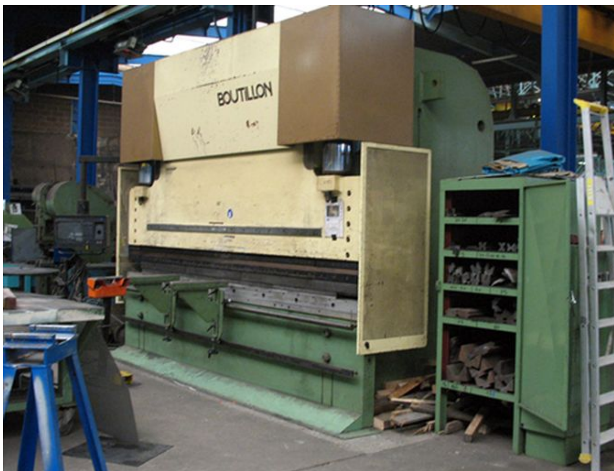
Machine à presser dans l'atelier de serrurerie.
