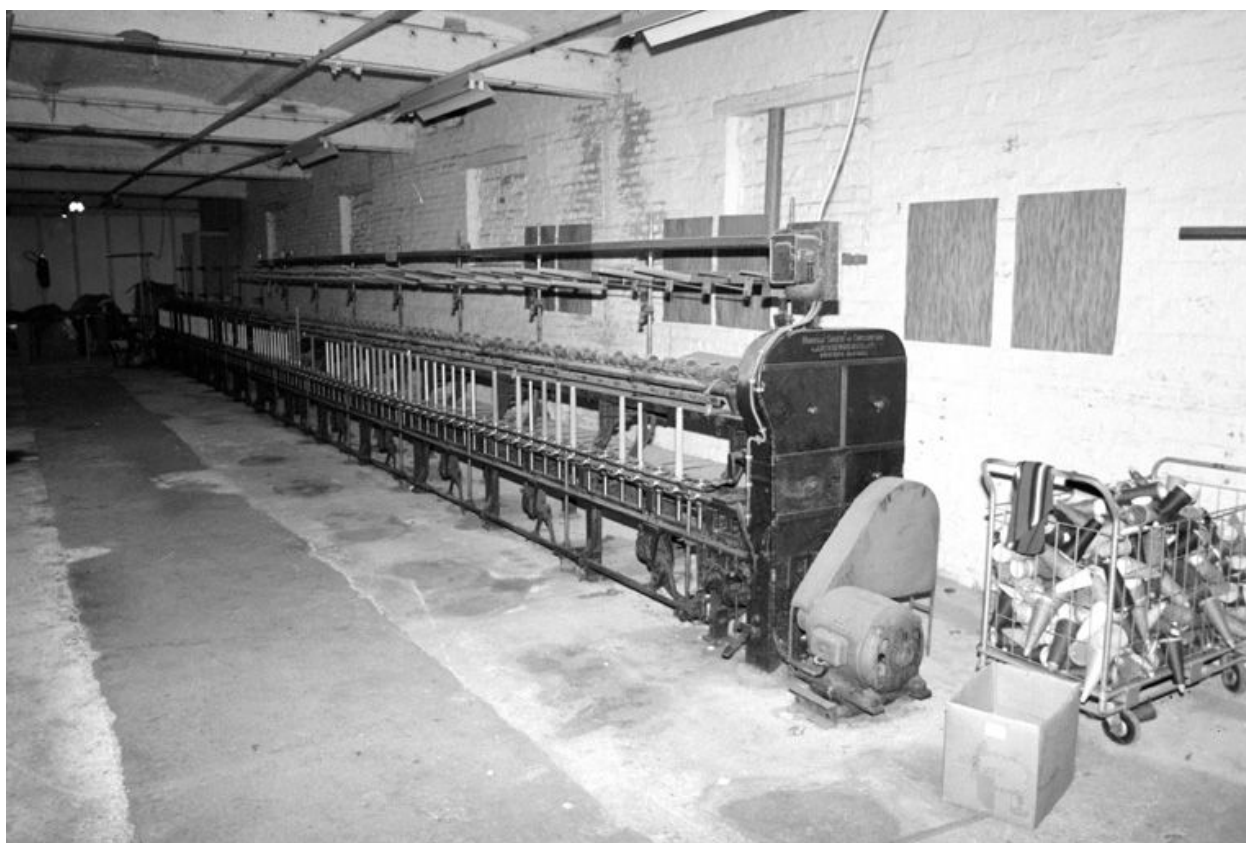
Machine continue à filer N.S.C. datant de 1923.
