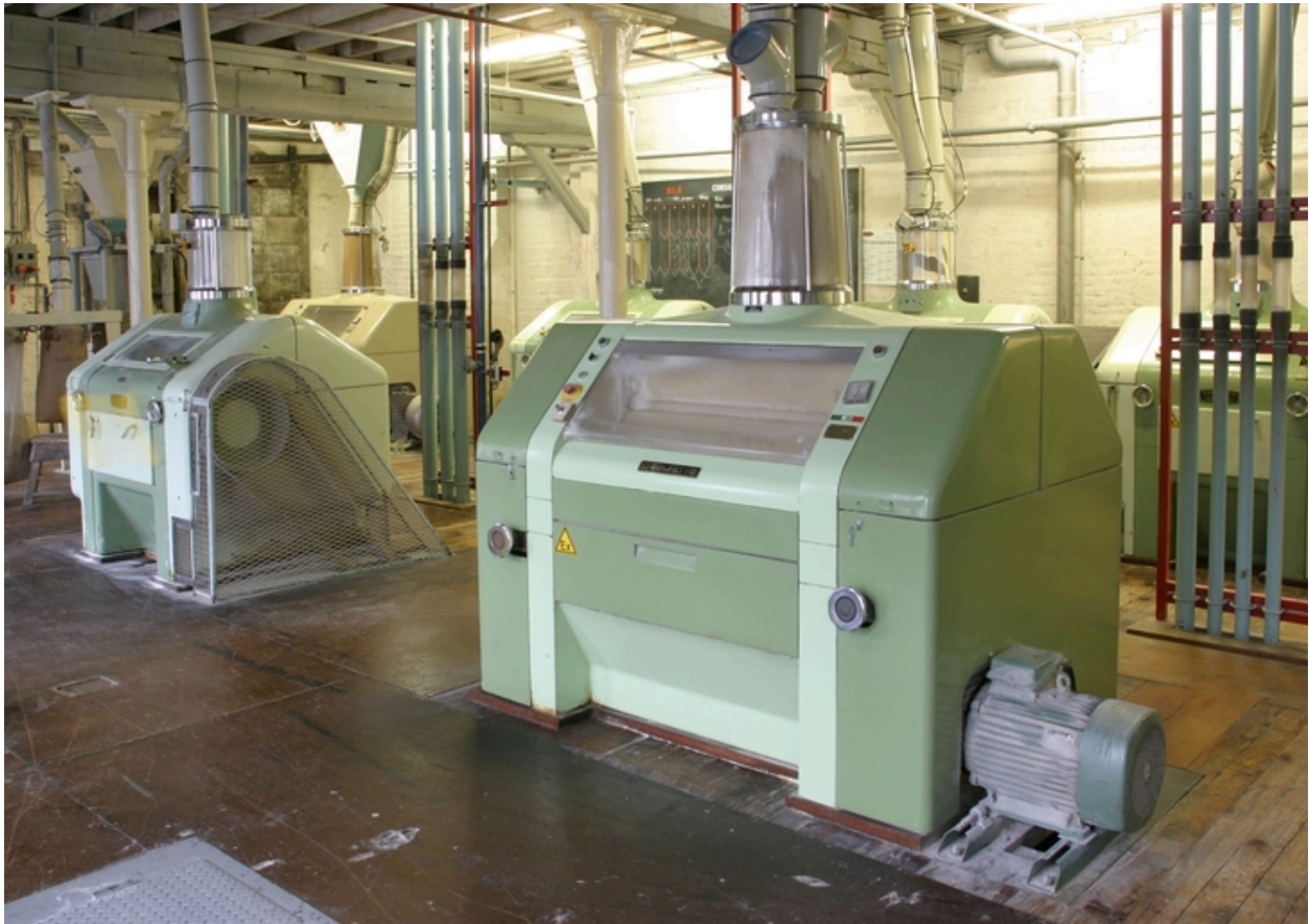
Premier étage de la minoterie : appareils à cylindres Golpetto.
