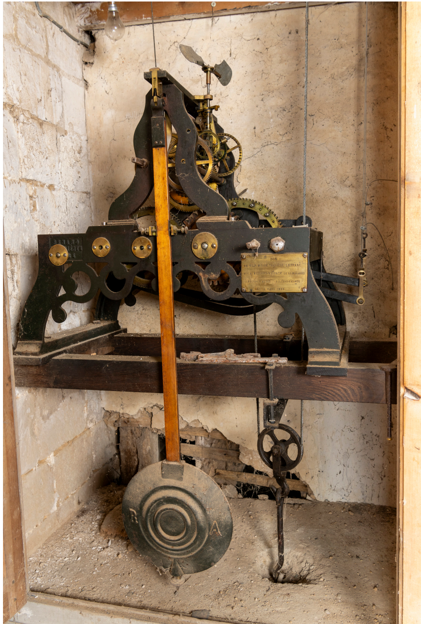
Mécanisme d'horloge, signé Renard à Ferrières (Oise), don de Marie-Thérèse Lefranc, quatrième quart du XIXe siècle.
