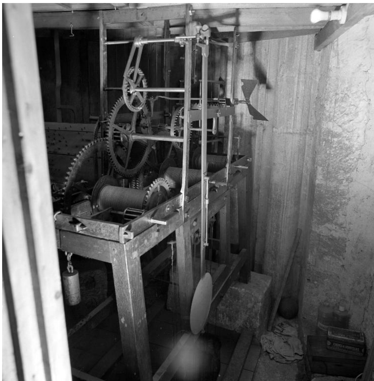
Vue de l'intérieur : les rouages et le balancier.
