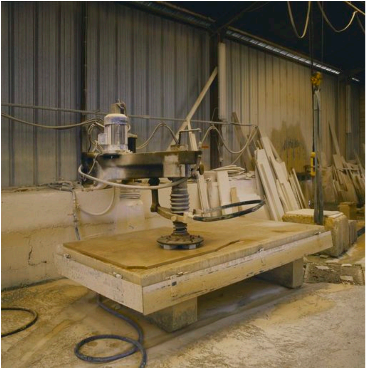
Machine à poncer la pierre (carrière Ouachée-Corpechot, Saint-Maximin).
