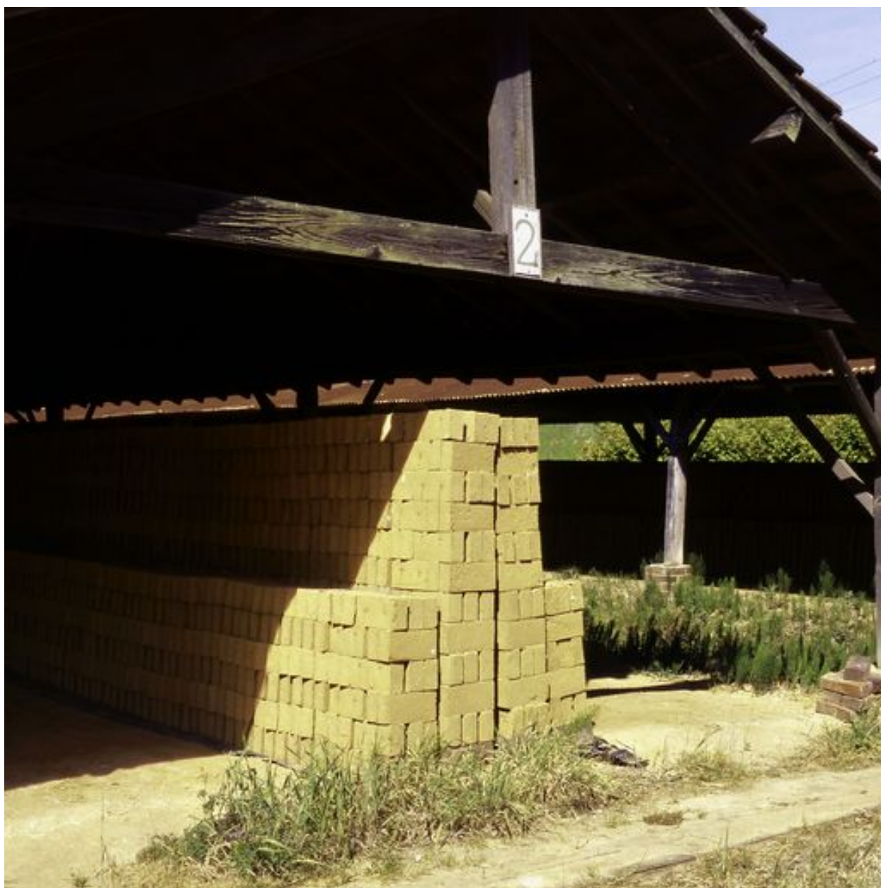
Les briques en cours de séchage sous l'une des halles.
