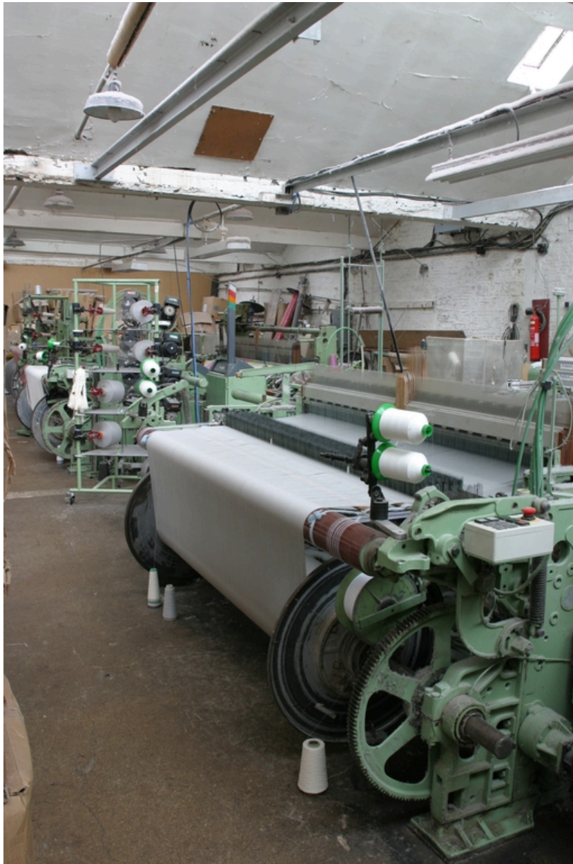
Machines à tisser à pinces dans les anciens ateliers de broderie de 1898.
