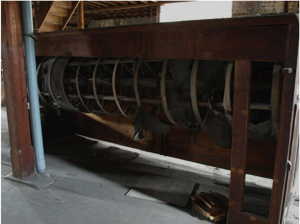
Vue générale du tamiseur circulaire.
