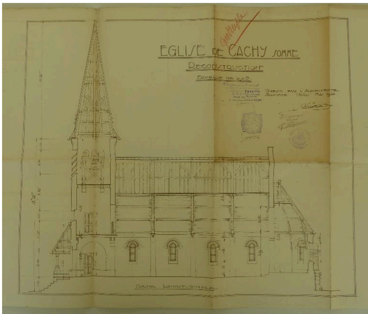
Eglise de Cachy (Somme). Reconstruction. Coupe longitudinale, Louis Duthoit, 1924 (AD Somme ; 99 O 879).
