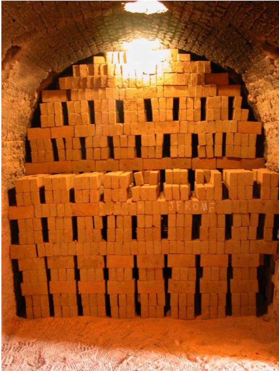
Vue intérieure d'une des chambres de cuisson, avec les briques mises à cuire.
