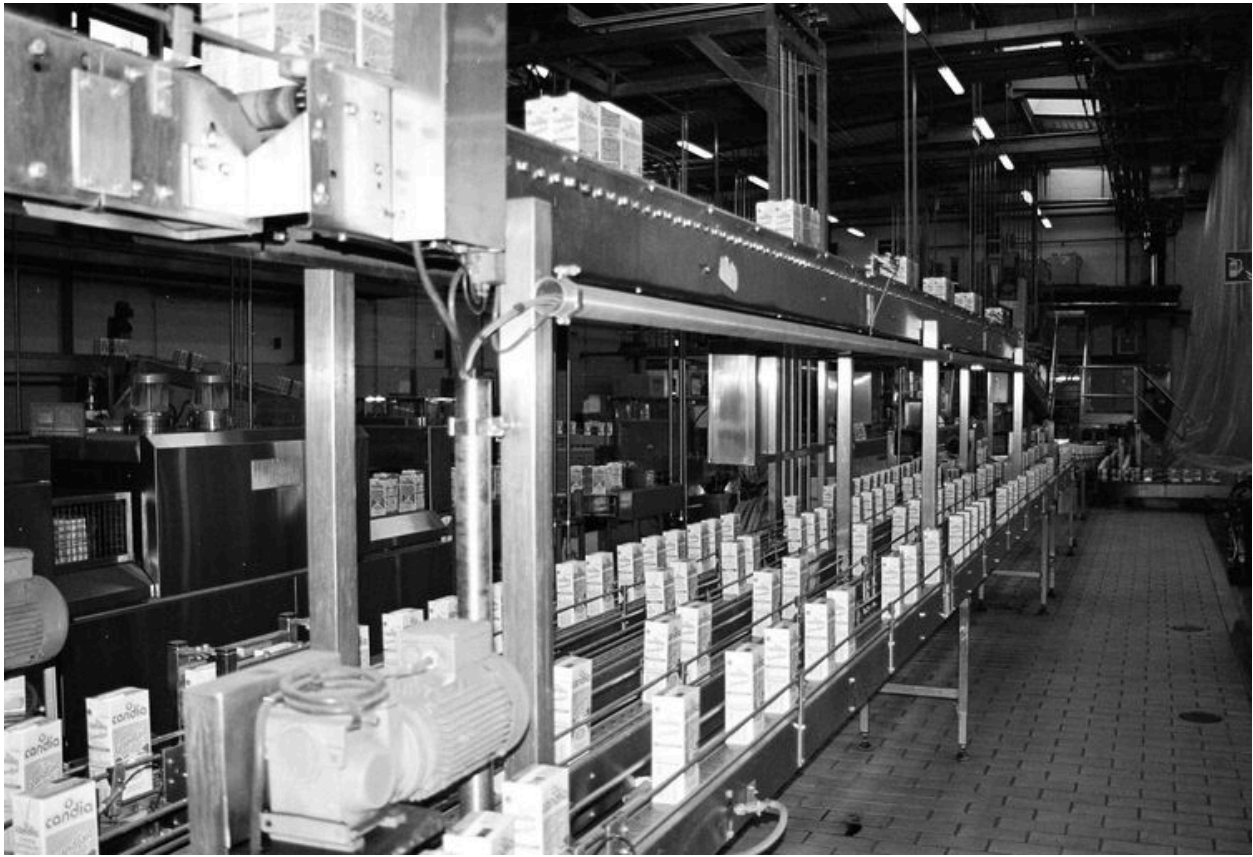
Atelier de conditionnement du lait : détail des tapis de transports des brick de lait.
