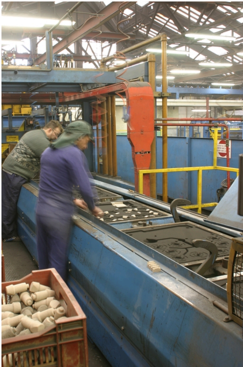
Préparation des moules (enlèvement des noyaux).
