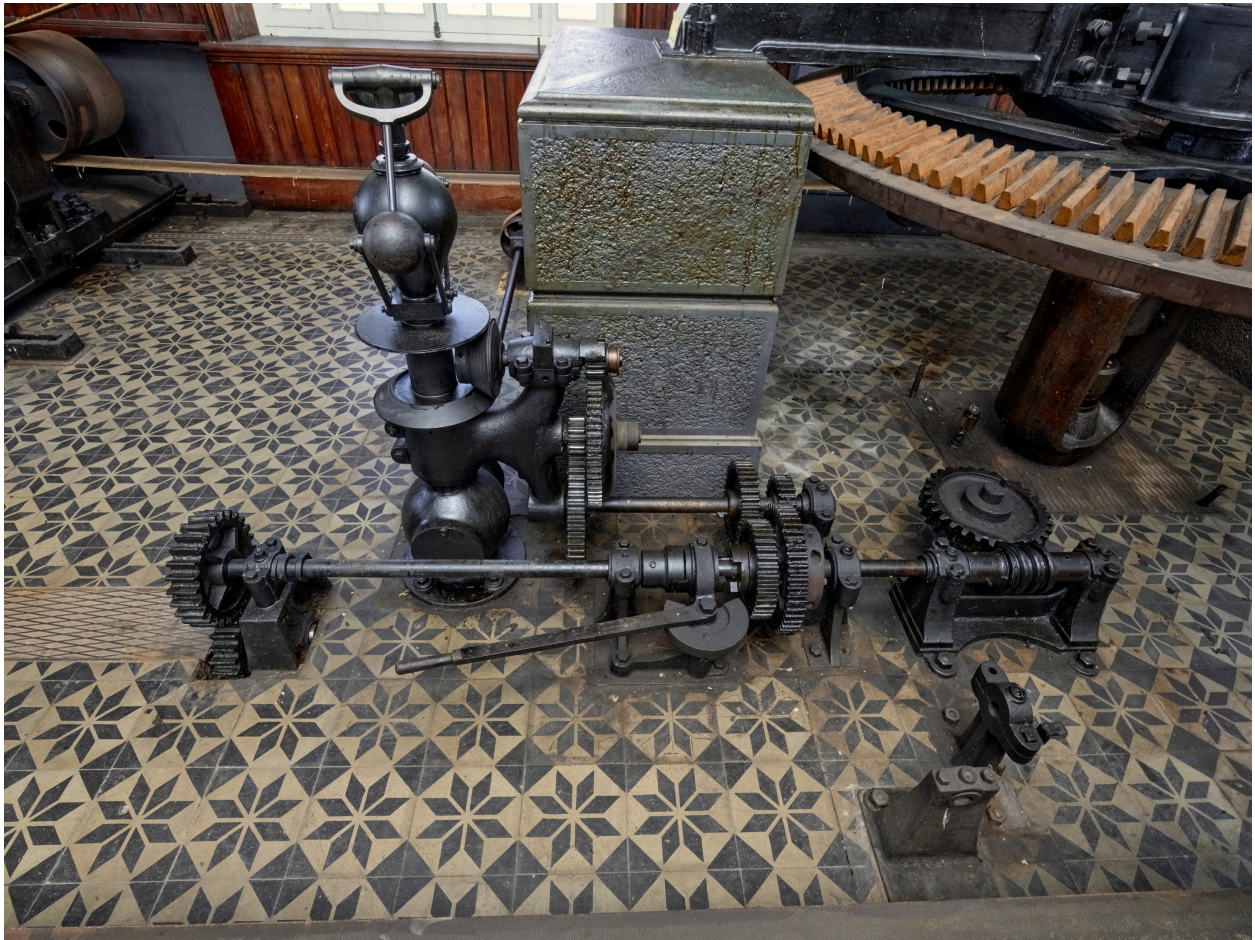
Intérieur, régulateur à boules.
