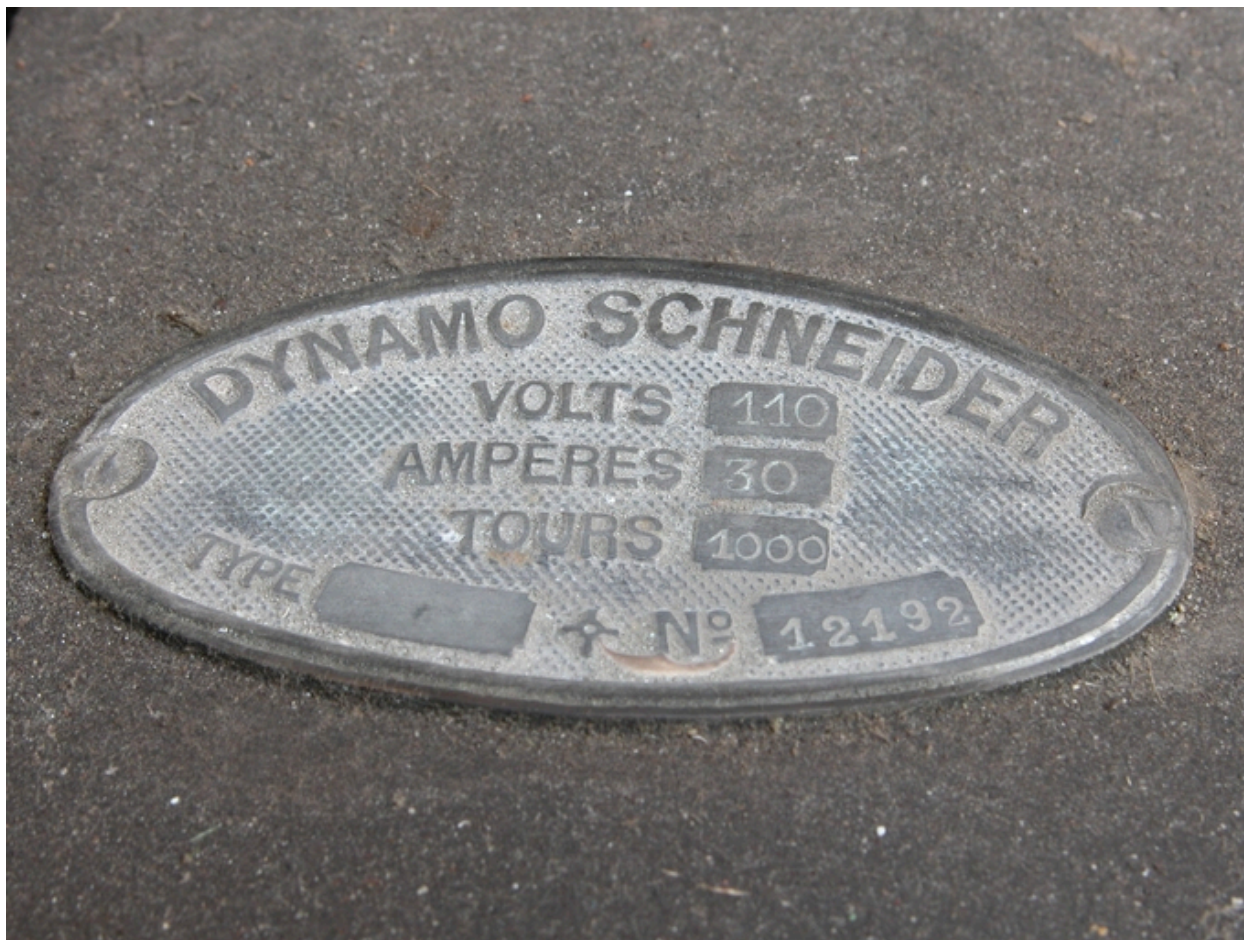
Plaque signalétique de la dynamo du générateur.
