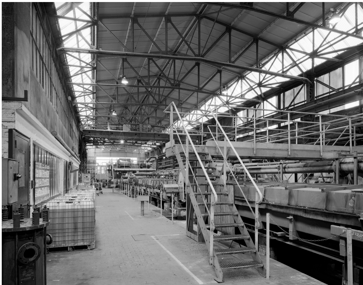
Vue générale de la halle de traitement des bobines : lavage, rinçage et traitement à l'acide.
