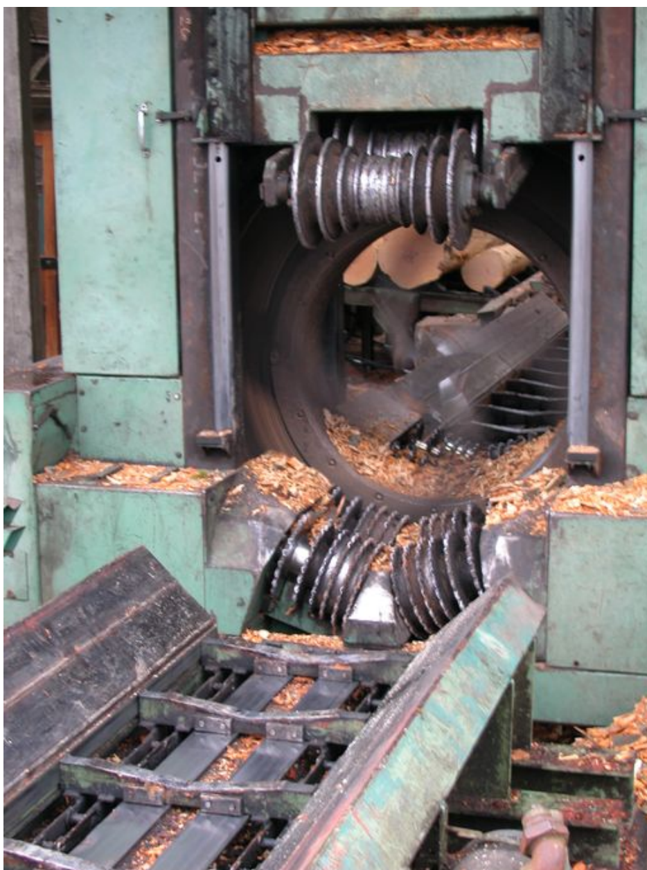
Machine à écorcer les grumes avant sciage.
