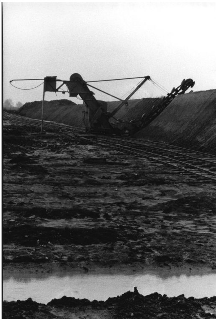
Carrière, excavateur à godets monté sur rails (AD Oise).
