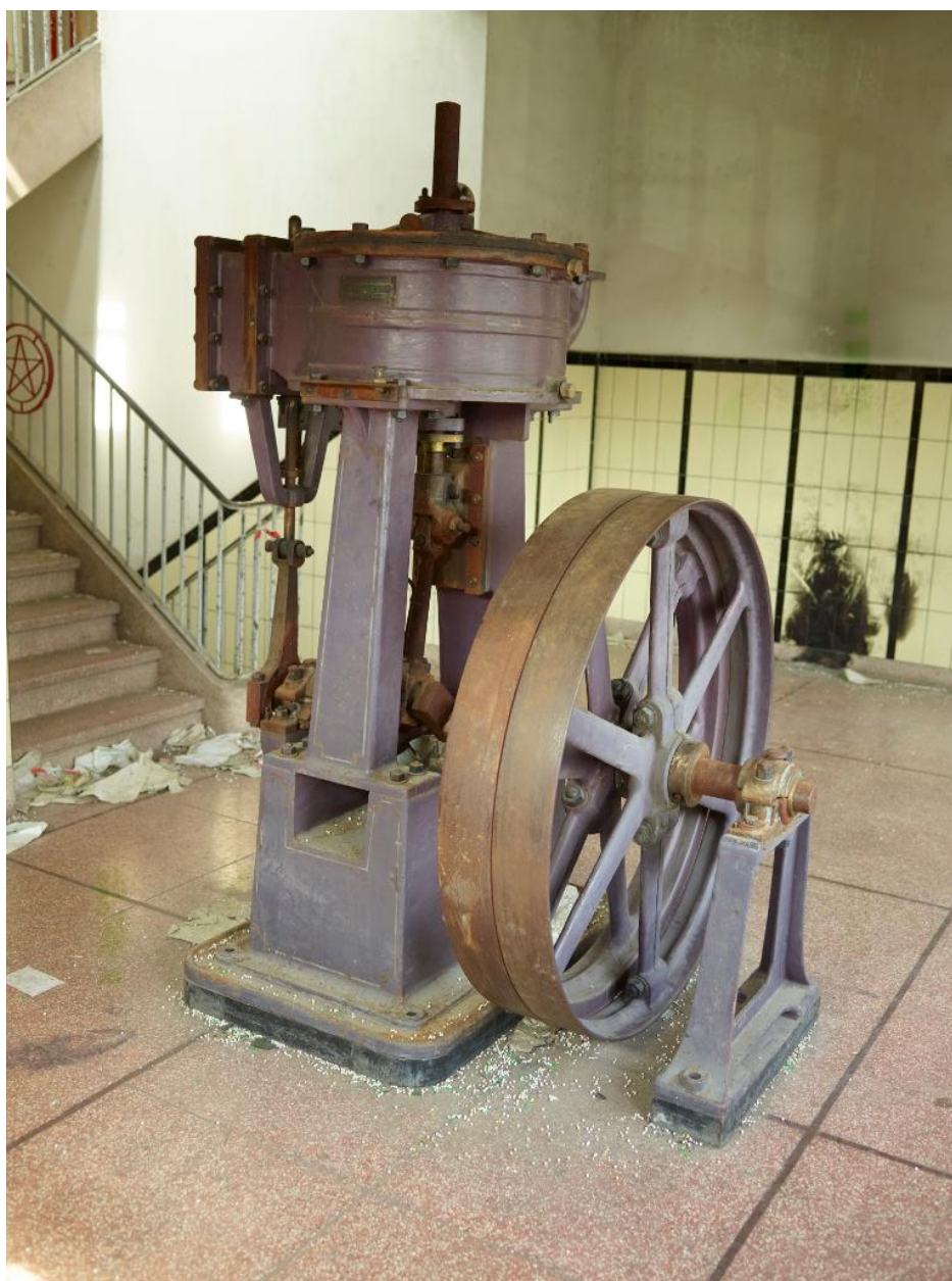
Pompe à vide à membrane. Atelier de construction Seck Frères (Dresdes) : vue antérieure en 2017.
