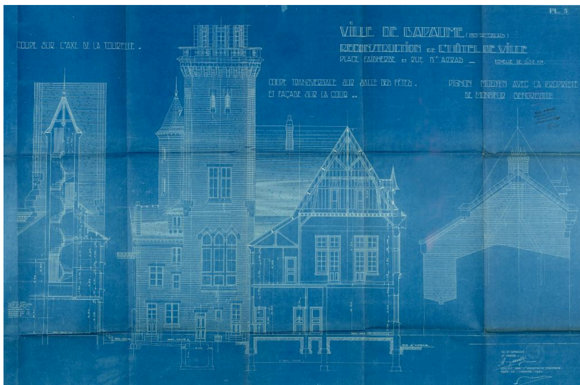
Ville de Bapaume - reconstruction de l'hôtel de ville - place Faidherbe et rue d'Arras : coupe sur l'axe de la tourelle ; coupe transversale sur salle des fêtes et façade sur la cour ; pignon mitoyen avec la propriété de M. Dengreville. Signé et daté Eugène Bidard (architecte) et Abel Guidet (maire), janvier 1930. (AD Pas-de-Calais, 20610/14).
